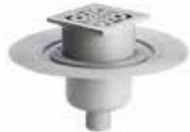
El **sumidero de piso de butech** es un sumidero para terrazas y pavimentos exteriores. Se caracteriza por un amplio disco alrededor de la rejilla lo que facilita la conexión a láminas impermeabilizantes. Disponible con salida vertical, permite resolver de una manera sencilla y eficaz la impermeabilización y drenaje de exteriores.
